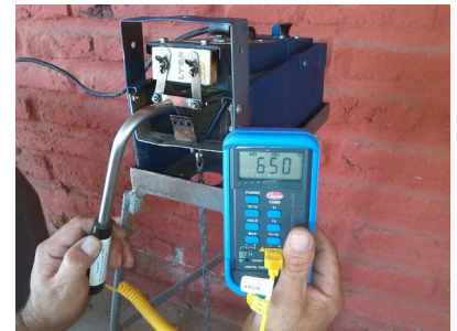
Pirómetro indicando la temperatura apropiada de la cuchilla de 650°C.
