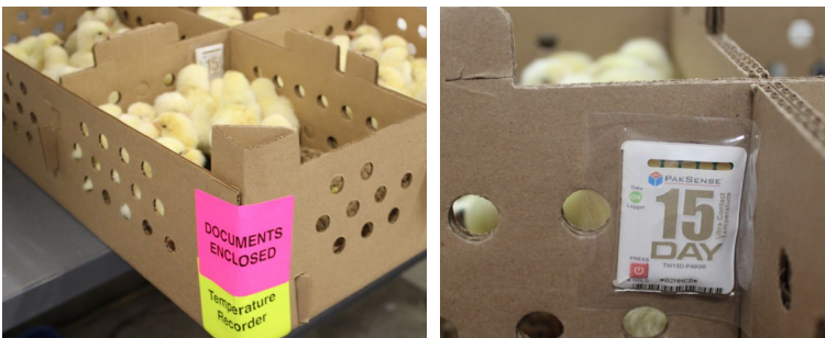
Los registradores de temperatura en las cajas con pollitas monitorean la temperatura durante el transporte desde la planta de incubación hasta la granja de reproductoras.
